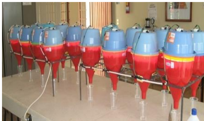
Figura 5.5.- Muestras de suelo en el embudo de Berlesse-Tullgren.
