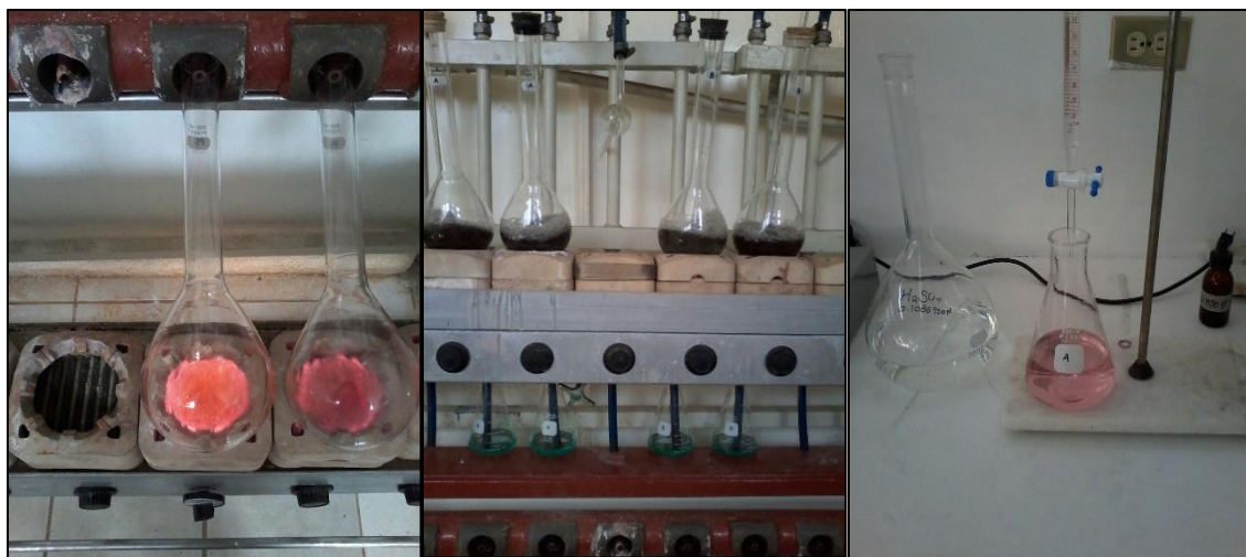
Figura 8. Equipo Kjeldhal utilizado para la determinación de nitrógeno (por conversión proteína cruda o bruta), se aprecian los 3 procesos que conlleva el método (digestión, destilación y titulación).
