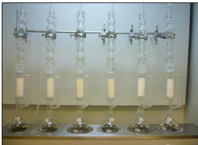
Figura 7. Equipo utilizado para la determinación de extracto etéreo por el método Soxhlet
