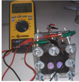
Figura 3.7. Medición de voltaje de forma directa en CCM
