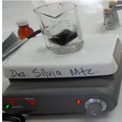
Figura 3.1. Polimerización química de electrodos con Politiofeno
