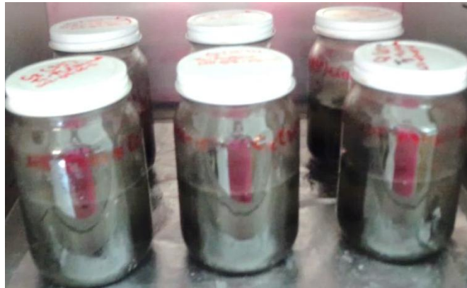
Figura 3.2. Acondicionamiento de electrodos en reactores batch de 250 mL.
