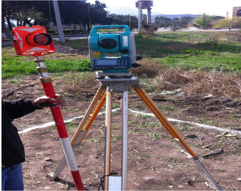
Figura 8. Establecimiento del punto pivote con estación total
