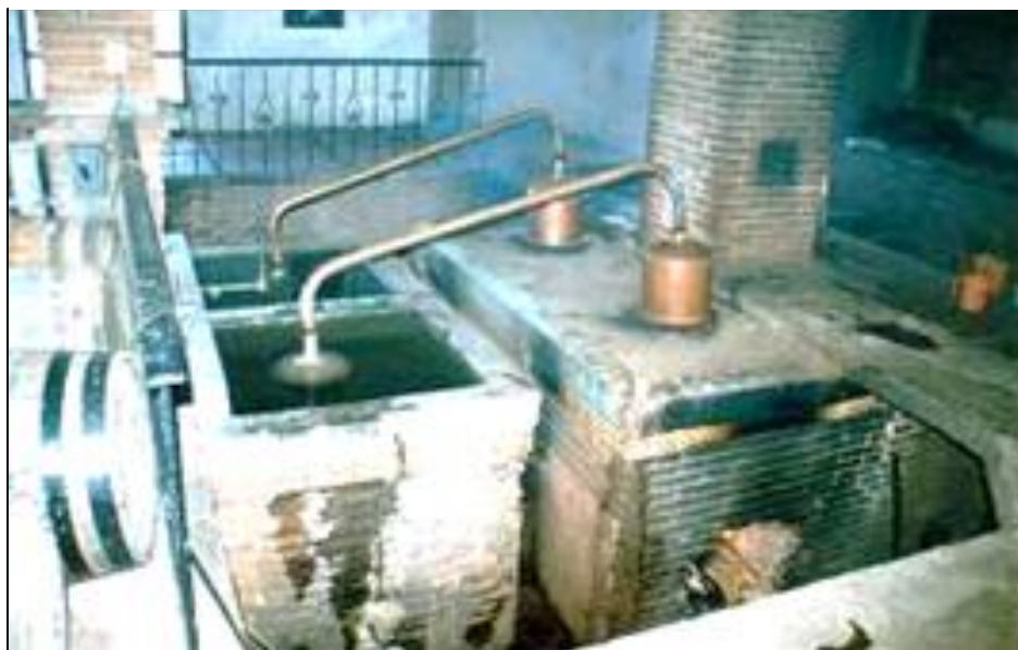
Figura 10. Alambique de destilación.
