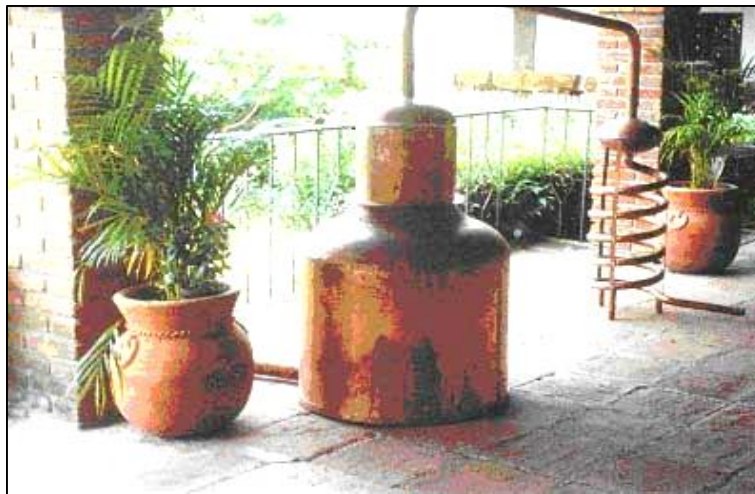
Figura 11. Campana y serpentín del alambique.
