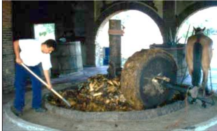
Figura 8. Acomodando los trozos de “piña” al centro del molino.
