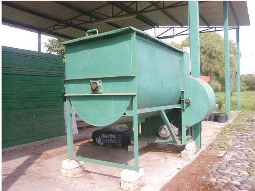
Imagen 7. Mezcladora de sustrato de 1m 3 de capacidad
