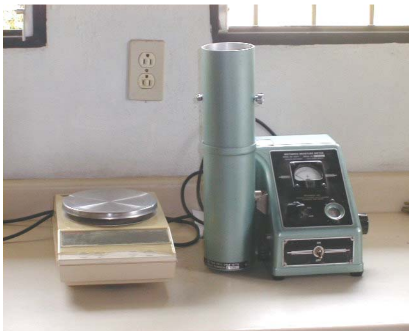
Imagen 2. Bascula electrónica de precisión y medidor de humedad
