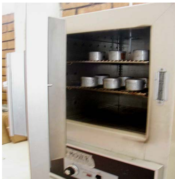
Figura 3.7. Horno con temperatura controlada para la disminución del contenido de humedad en las semillas.
