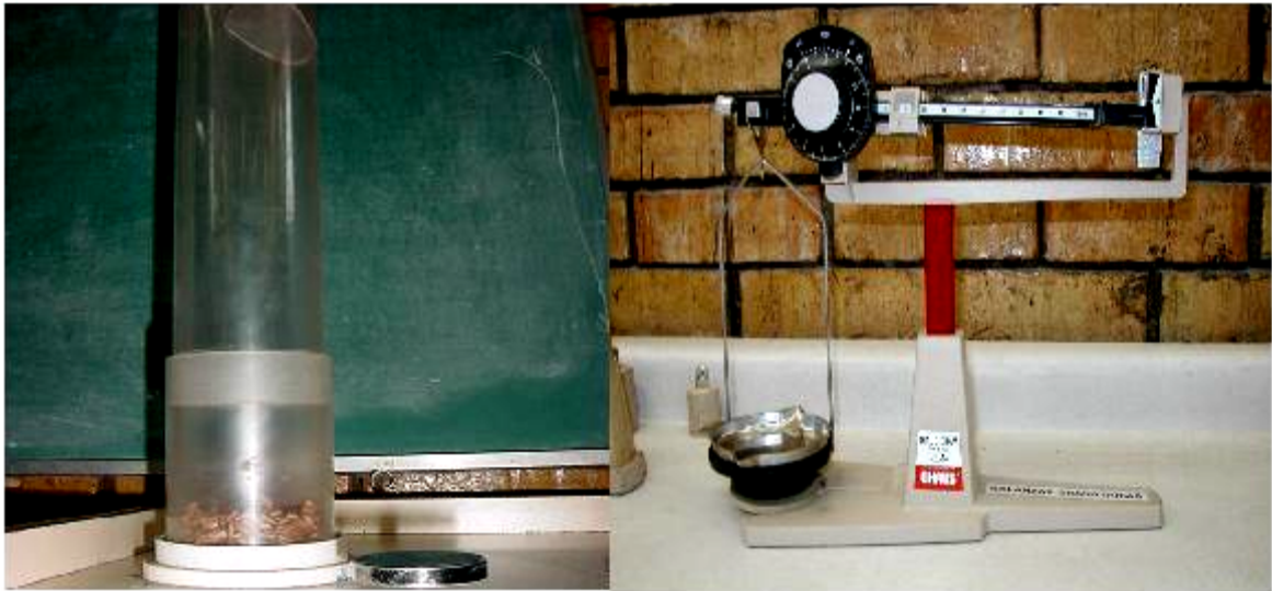
Figura 3.5. Separador neumático y balanza analítica de barra. Instrumentos de laboratorio básicos para llevar a cabo eficientemente la prueba de pureza.
