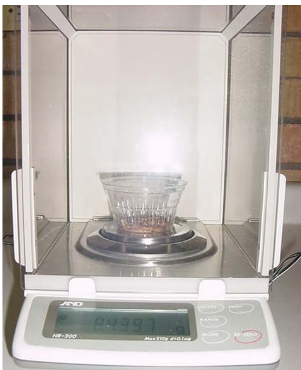
Figura 3.6. Balanza digital con alta sensibilidad utilizada para la lectura del peso de 1000 semillas.
