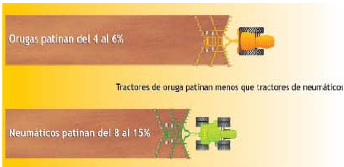
Figura 2.3 Compactación por patinaje
