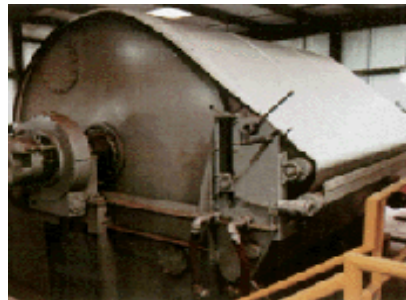
Figura 2.8. Filtro de tambor. Fuente: (diquima2007).
