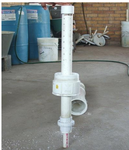
Figura 3.10. Ensamble del tubo de entrada del biogás con las conexiones.
