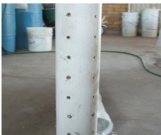
Figura 3.9. Tubo perforado para la salida del biogás.
