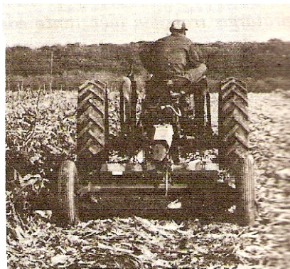
Fig. 2.13 Cortadora de eje vertical cortando rastrojos de maíz (Harris S. A. E. 1965)
