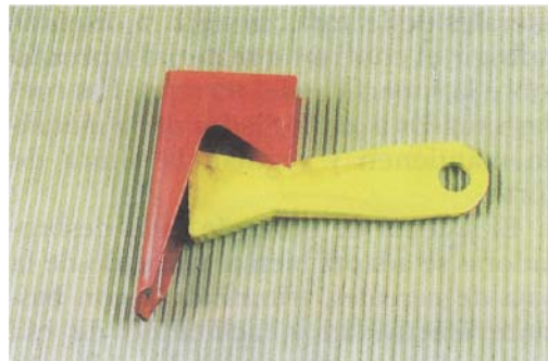
Figura 2.17 Detalle del martillo y la contra cuchilla, sistema que utilizan algunas máquinas (Laguna A.)
