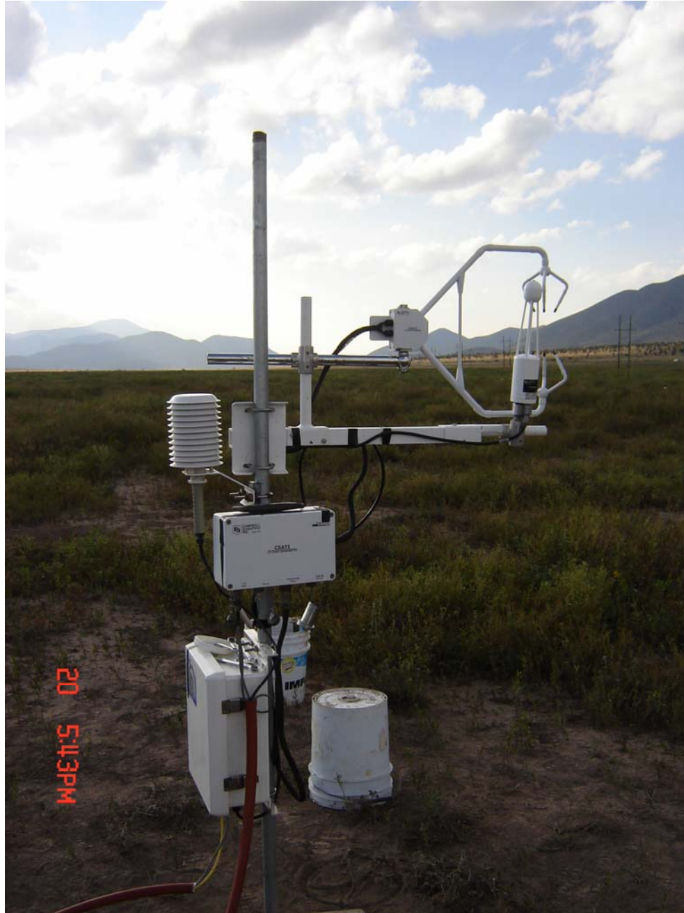
Figura 3.4 Sistema eddy en la parcela de labranza testigo (sin movimiento de suelo) para medir los flujos de calor latente ( \lambda E ) y flujo de CO_2 entre la superficie y la atmósfera circundante.
