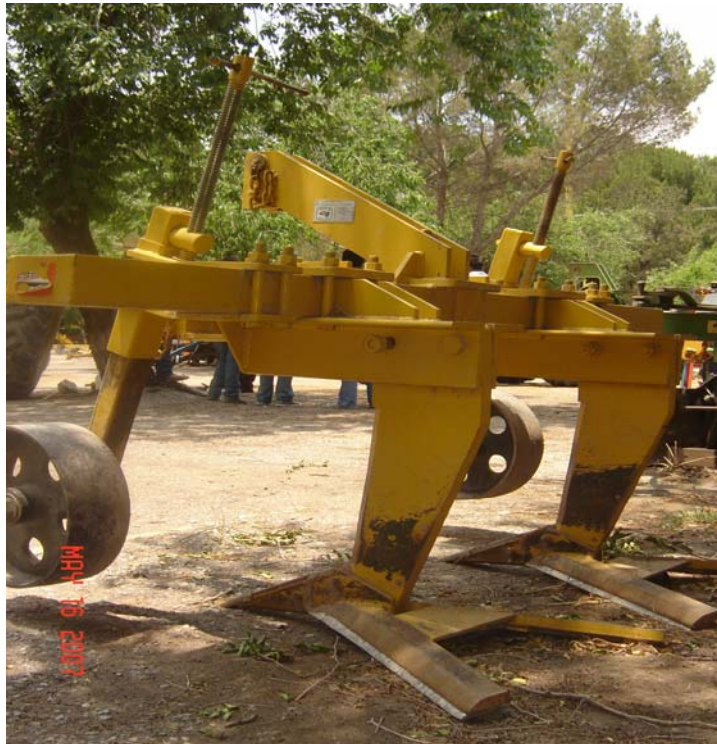
Figura 3.2 Arado de tipo Cincel con aletas en delta y de un ancho de trabajo de aproximadamente 1.5 mts.
