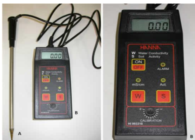
Fig. (2.8). Activímetro de HANNA Instruments (HI993310): para medir la conductividad eléctrica de una disolución (W) ó la actividad del suelo (S).
