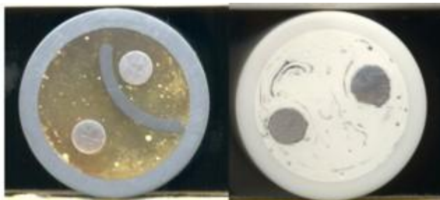
Fig. (2.12) Comprobación de electrodos Preparación de Soluciones de Calibración Standard. Se prepara una serie de patrones o soluciones Standard de Conductividad Eléctrica conocidas partiendo de Cloruro de Potasio (ClK). Esto es necesario con el fin de verificar la linealidad del instrumento y obtener a su vez la curva (recta) de calibración.
