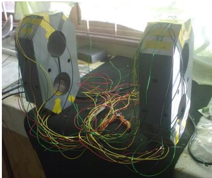
Figura C5 Cableado de sensor octagonal
