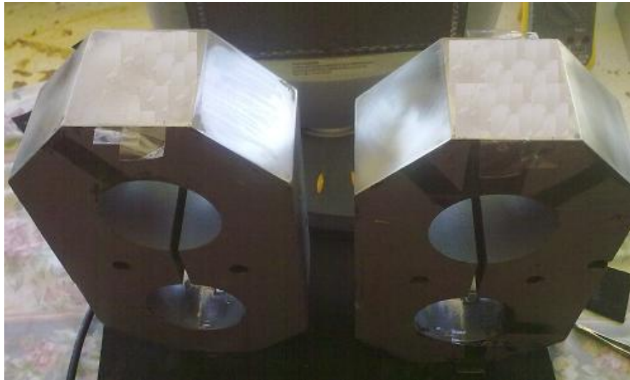
Figura C1 Octagonal lijado, listo para la colocación de las galgas
