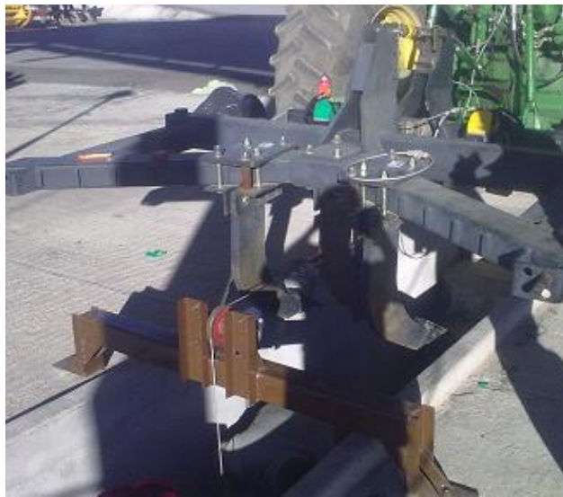
Figura 4.3 Calibración de la fuerza horizontal del Sensor Integral, Octagonal y Axial.
