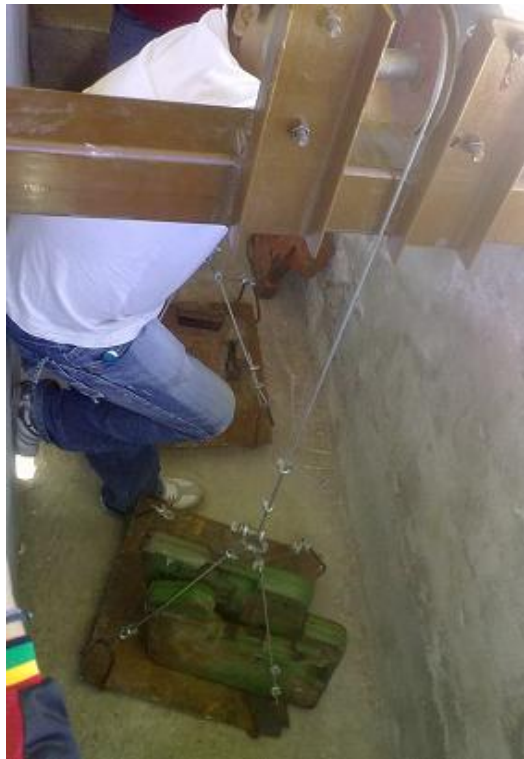
Figura D4 Colocación de pesos
