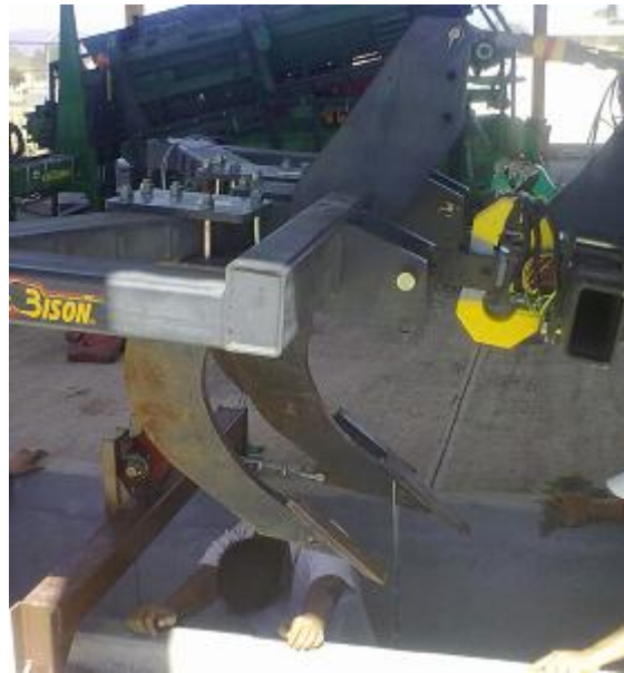
Figura 4.12 Calibración de fuerzas combinadas, del Sensor Integral, Octagonal y Axial.
