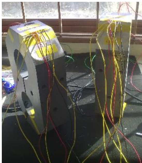
Figura 4.2 Galgas montadas y cableado.
