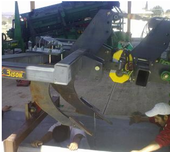
Figura 4.6 Calibración de la fuerza vertical del Sensor Integral, Octagonal y Axial.
