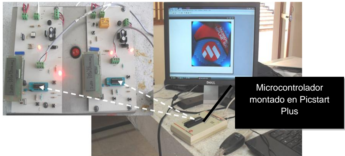
Figura 7.7 Posición de los microcontroladores en las placas de control
