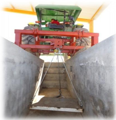
Figura 4.5. Calibración del sensor vertical (FY) aplicada al octagonal extendido.
