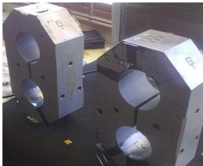
Figura 6.3. Colocación de las galgas extensiométricas en el octagonal extendido.
