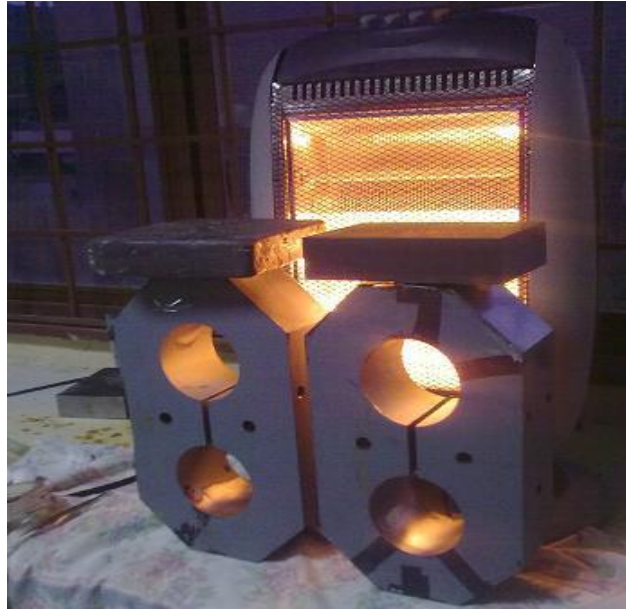
Figura 6.4. Proceso de secado del acoplamiento de galgas pegadas a los octagonales extendidos.
