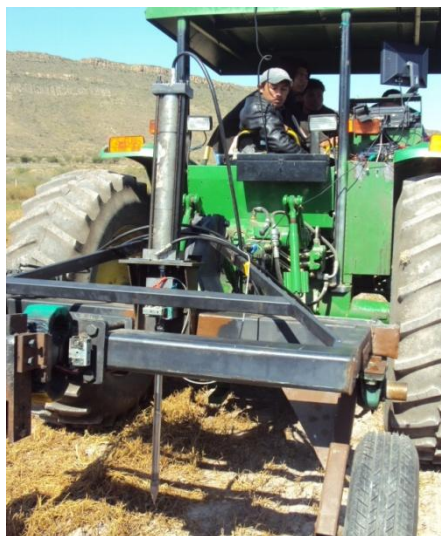
Figura 13. Penetrómetro acoplado al tractor
