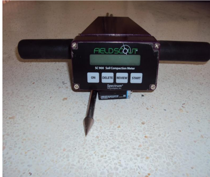
Figura 15. Penetrómetro digital sónico FIELDSCOUT SC 900
