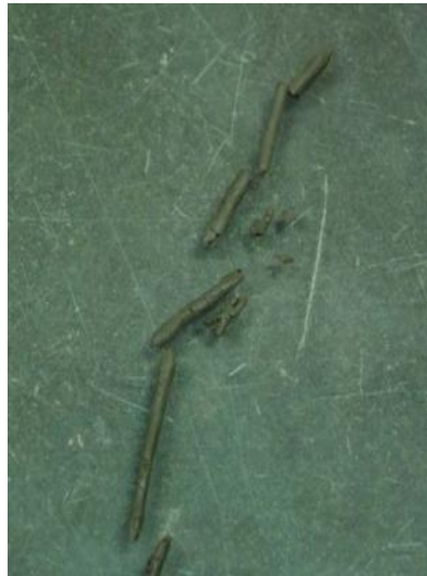
Figura 18. Muestra de suelo en su límite plástico
