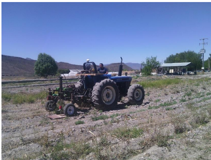
Figura 5.15 Calibración y nivelación del carro porta-sensor (RPS)
