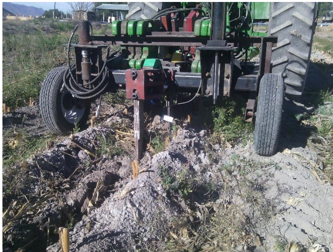
Figura 5.14 Calibración y nivelación del carro porta-sensor (RRS)
