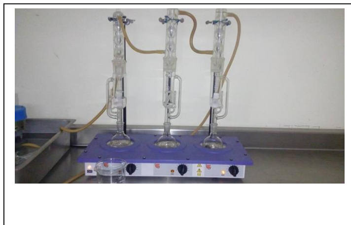
Figura. 5 Extracción de grasa cruda con soxhlet
