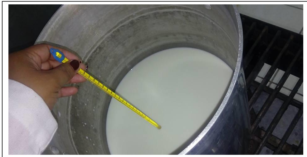
Figura. 1 Pasteurización de la leche de cabra por el método convencional VAT
