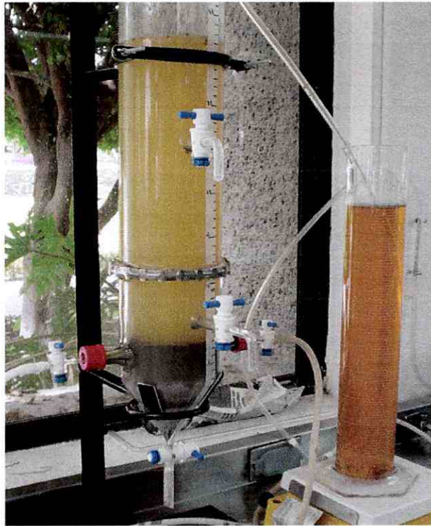
Figura 3: Torre de desorción de sulfuros
