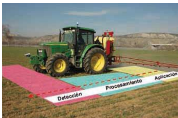
Figura 4. Sistema de tratamiento en tiempo real con sensor de vegetación situado al frente del tractor
