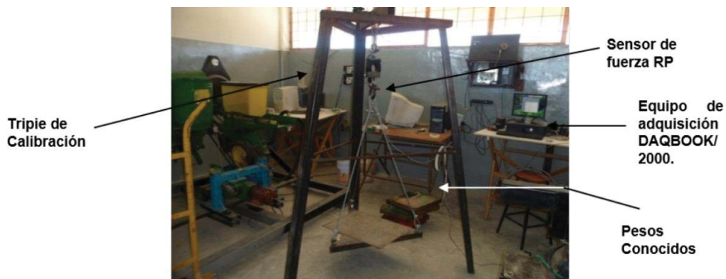
Figura 17. Calibración de sensor de fuerza para el penetrómetro
