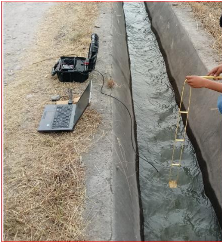
Figura 8.-Medición de gasto en canal utilizando el medidor de flujo fluxsense.
