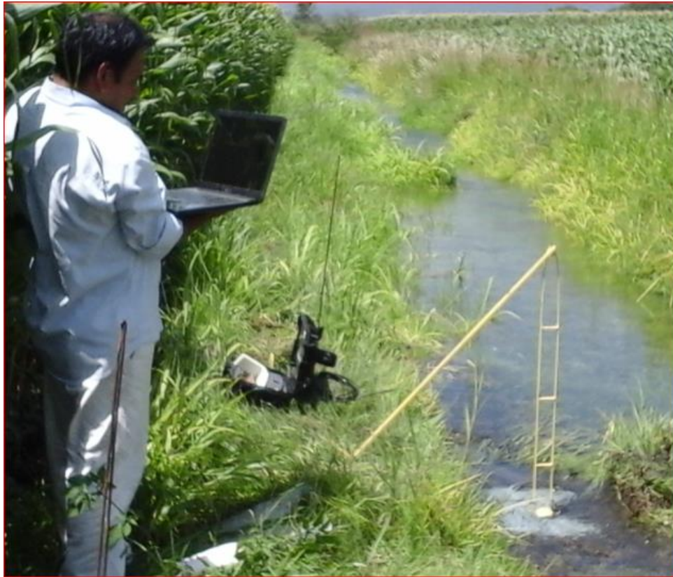
Figura 1.-Medición de gasto en la zanja regadora durante prueba de riego.
