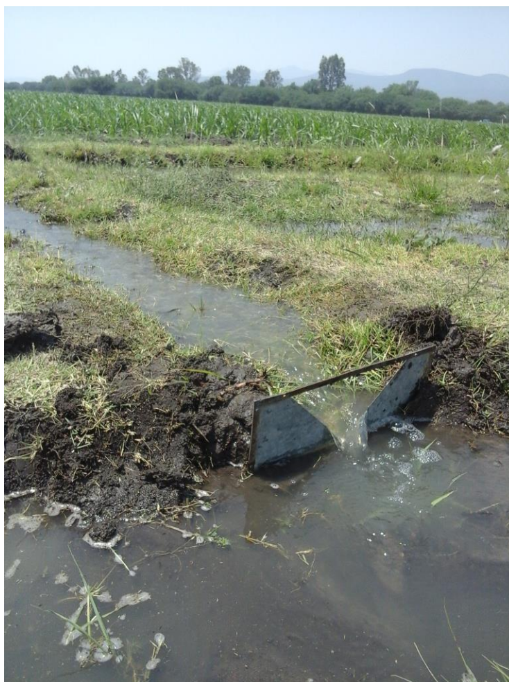
Figura 9.-Medición de gasto utilizando vertedor triangular de pared delgada.
