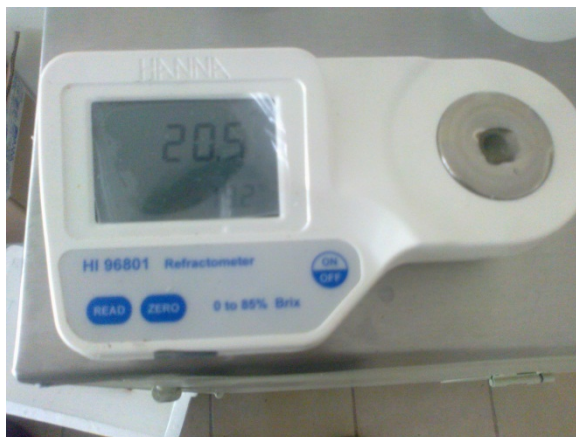
Figura 3.15 Medición de los Grados Brix con el Refractómetro
