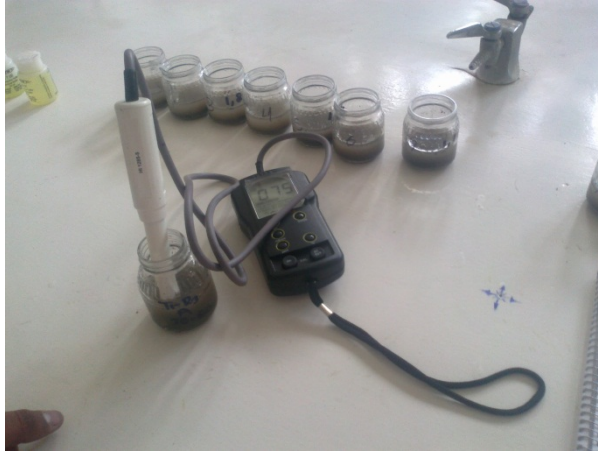
Figura 3.10 Conductividad Eléctrica: Método de la Pasta Saturada
