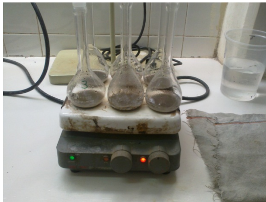
Figura 3.6 Densidad de Sólidos: Método del Picnómetro
