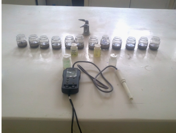
Figura 3.9 Medición de Potencial de Hidrogeno.
