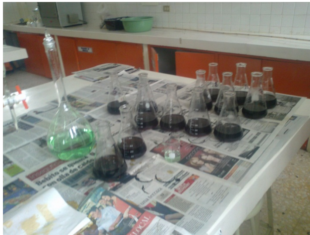
Figura 3.7 Determinación de Materia Orgánica con el Método de Walkley y Black
