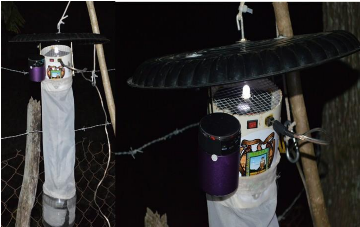
Figura 8 Trampa de luz CDC con bocina que reproduce el sonido del canto de ranas
