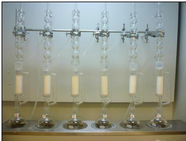
Figura 15. Equipo utilizado para la determinación de extracto etéreo por el método Soxhlet.
