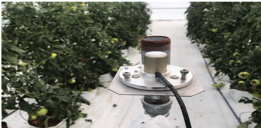
Figura 3. Medidor de radiación PAR Quantum sensor (SQ-512, Apogee, Instruments, Logan, Utah, USA).
