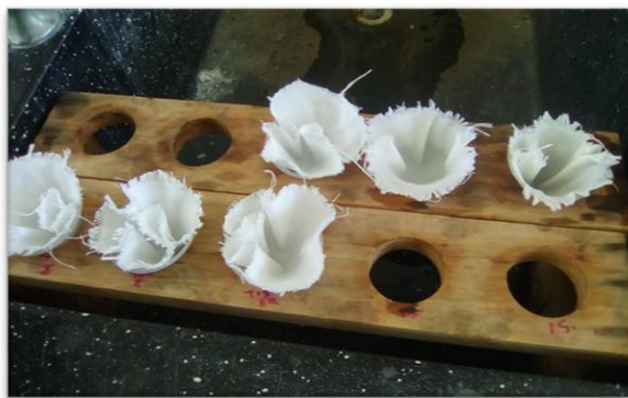
Figura 7. Filtrado de muestra para secar la fibra obtenida
