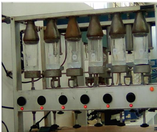
Figura 6. Digestión de muestra para obtención de fibra cruda
