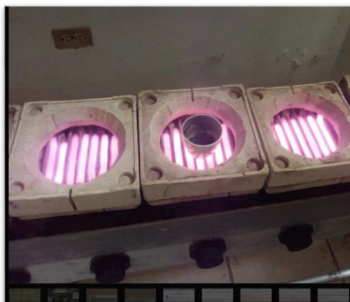
Figura 8. Incineración de muestra en parrilla Kjeldahl
