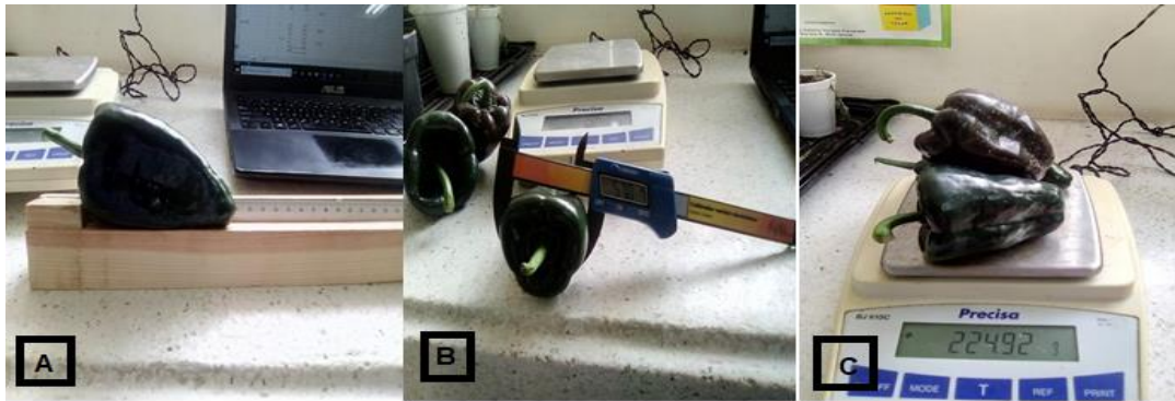
Figura 1. A) Longitud de fruto; B) Diámetro de fruto; C) Peso de tres frutos.
