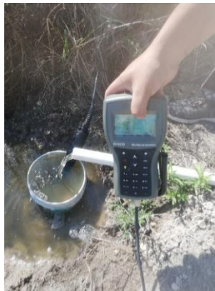
Figura 35.- Sonda multiparamétrica tomando lecturas durante una prueba.
