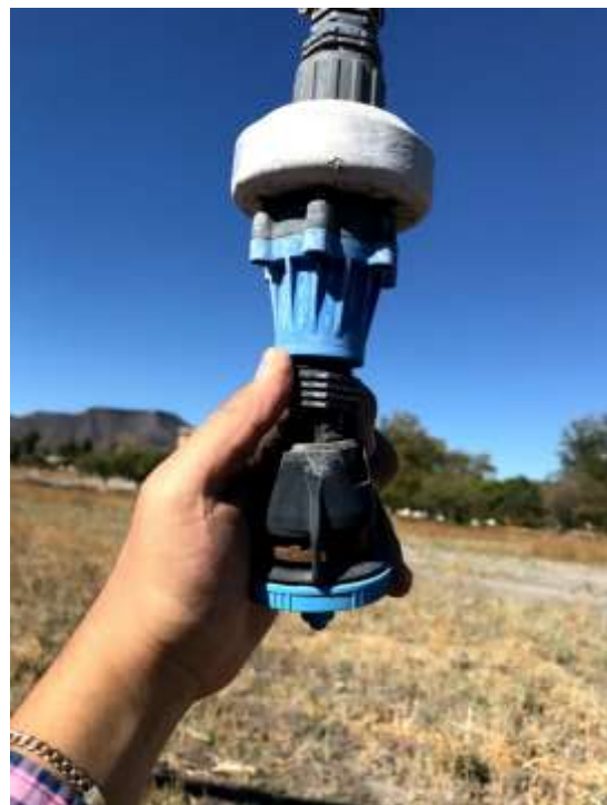
Figura 19.- Cuerpo completo de rotor R3000.
