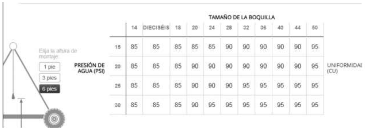
Figura 13.- Esquema de la uniformidad del riego que el fabricante oferta para los tamaños de boquillas sometido a diferentes presiones a 6 pies de altura.
