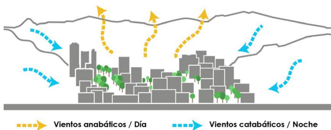
Figura 1. Influencia de vientos anabáticos y catabáticos (De la Luz. G, Hernández. A, Castro. M, García. J, & Zuri. I, 2015).
