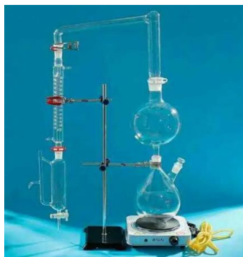
Ilustración 6. Destilador por arrastre de vapor (ARKOLAB, 2021)
