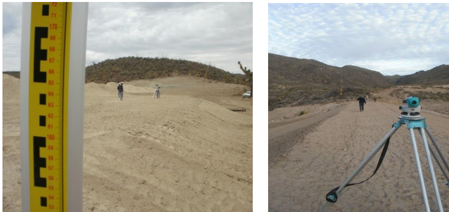
Imagen 15. Supervisión de obras. Medición de terraplén de bordo de tierra para abrevadero
