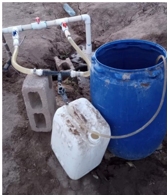
Figura 8. Aplicación de fertilizante por Venturi.
