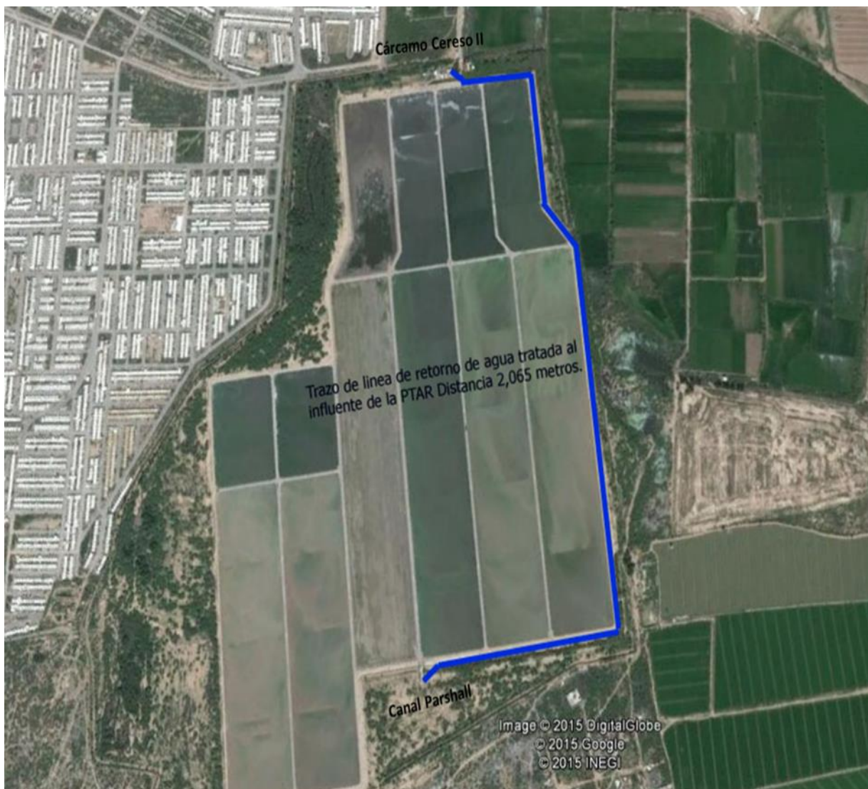
Figura 8. Tubería de recirculación del agua al influente
