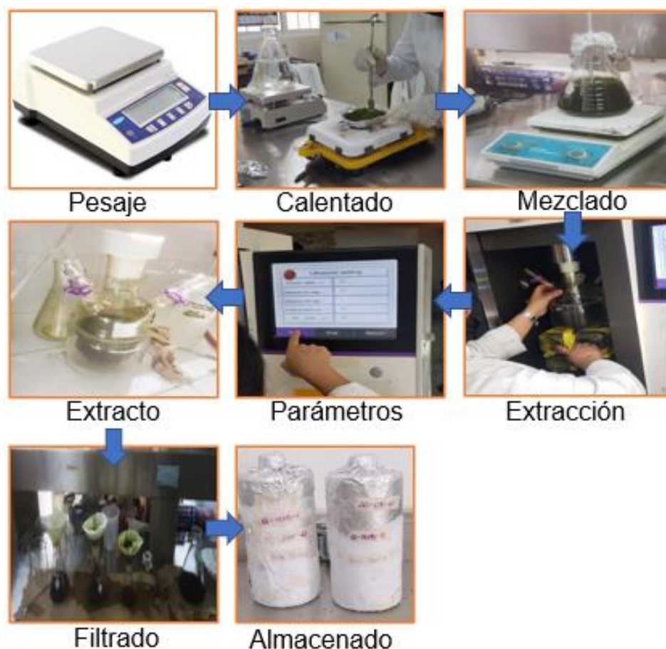
Figura 8. Proceso de obtención de los extractos de esquilmos de brócoli por Sistema Híbrido.
