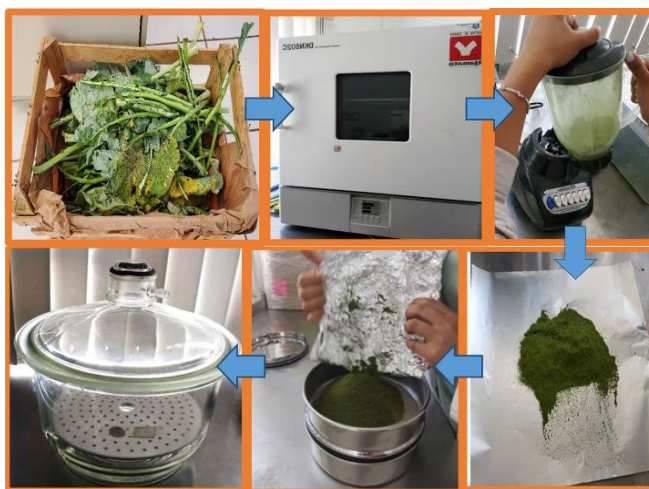
Figura 7. Proceso de obtención de polvos de esquilmos de brócoli.
