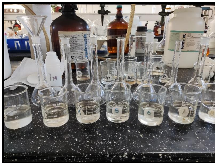
Figura 15. Vasos de precipitado con mezcla de \text{HClO}_4 y \text{HNO}_3 después de la ebullición
