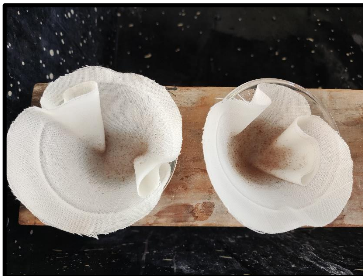
Figura 14. Muestra filtrándose en embudos con tela de Lino
