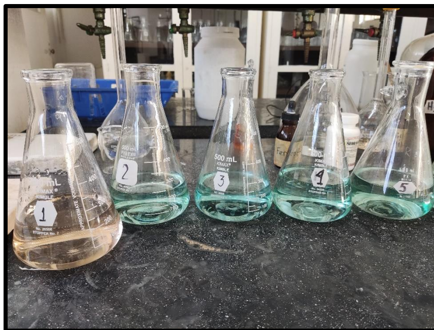
Figura 11. Matracas Erlenmeyer con destilado, a la izquierda matraz titulado con H 2 SO 4
