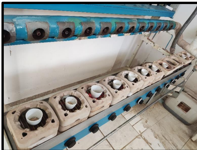
Figura 9. Crisoles en parrillas eléctricas
