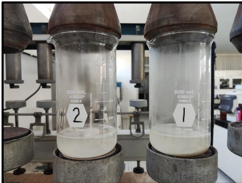
Figura 13. Vasos de Berzelius con muestra desengrasada en ebullición
