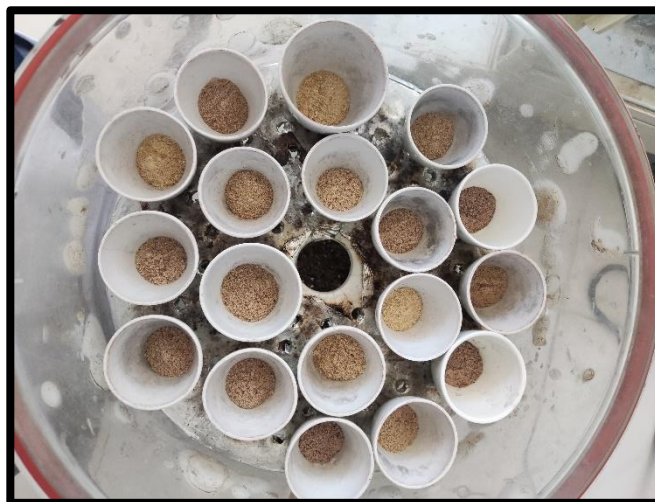
Figura 8. Muestra molida y pesada en crisoles de porcelana
