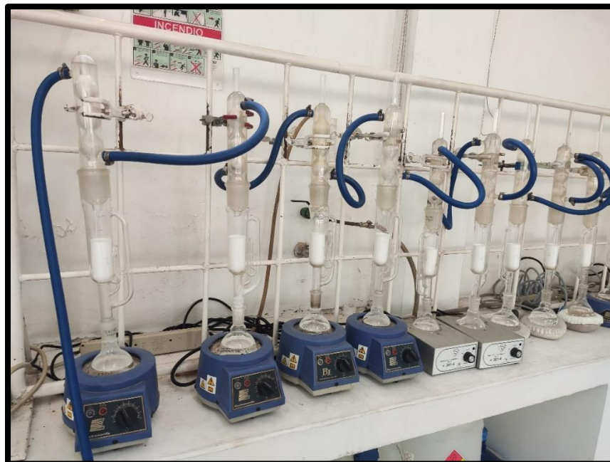
Figura 12. Muestra desengrasándose en el equipo Soxhlet
