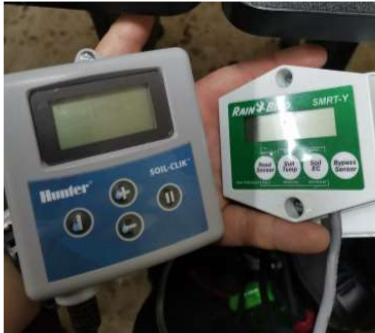
Imagen 29 Modem de sensores de humedad Hunter y Rain Bird
