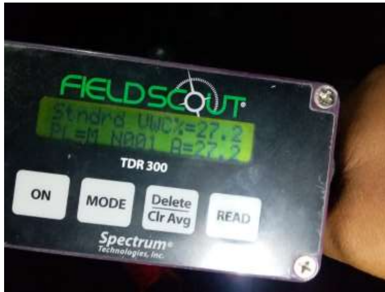
Imagen 40 Lectura de porcentaje de humedad de la sonda TDR
