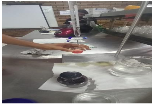
Figura 7. Titulación con una solución de NaOH al 0.1 para obtener los datos de la variable de acidez titulable.
