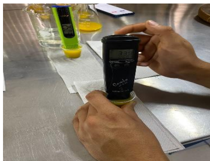
Figura 4. Lectura de una muestra macerada de fruto de pimiento para la medición del pH con un medidor de bolsillo.
