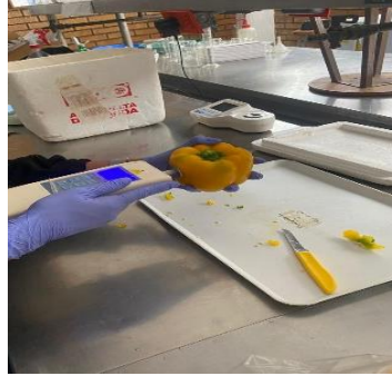
Figura 5. Lectura de la variable firmeza con ayuda de un penetrómetro.
