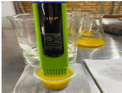
Figura 6. Medición de la variable ORP en una muestra macerada de fruto de pimiento con ayuda de un medidor de ORP.
