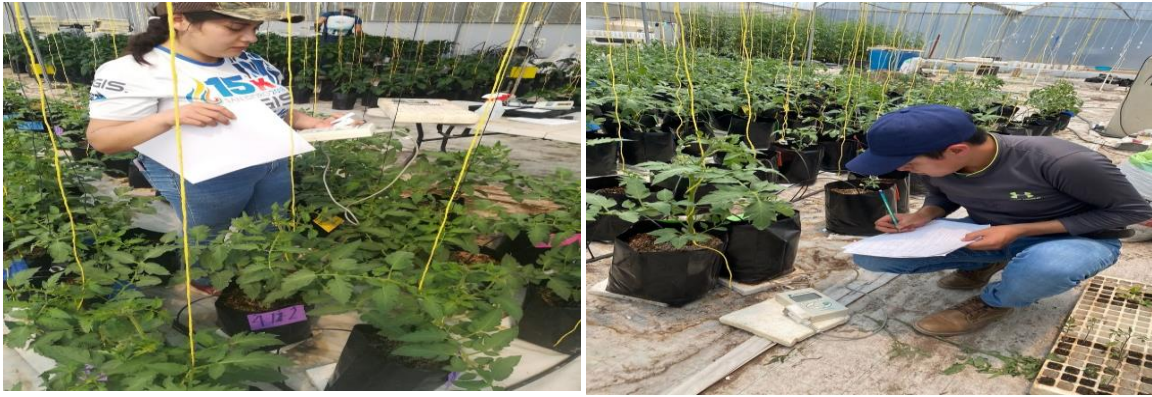
Figura 9. Evaluación de conductancia estomática con porómetro (marca DECAGON DEVICES, INC).
