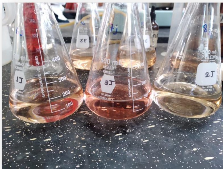
Figura 15. Titulación de destilado hasta obtener color rosa pálido
