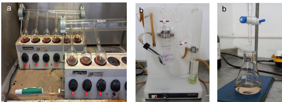
Figura 8. Proceso de Digestión de muestras (a) y determinación de proteínas (b).
