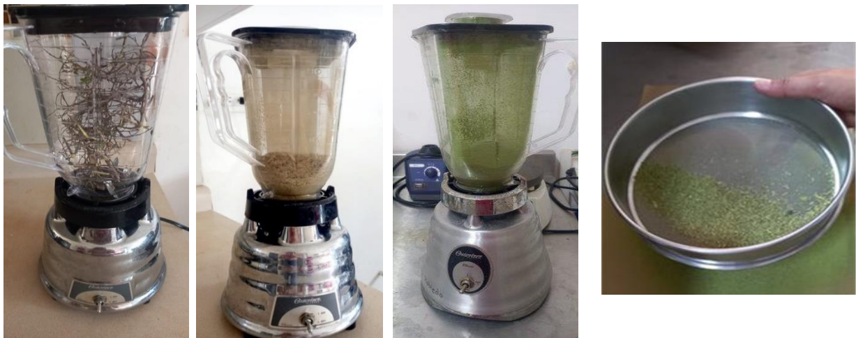
Figura 7. Proceso de secado, triturado y tamizaje de hojas y ramas
