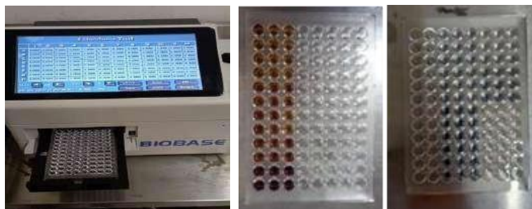
Figura 10. Reacciones de capacidad antioxidante en lector de microplacas
