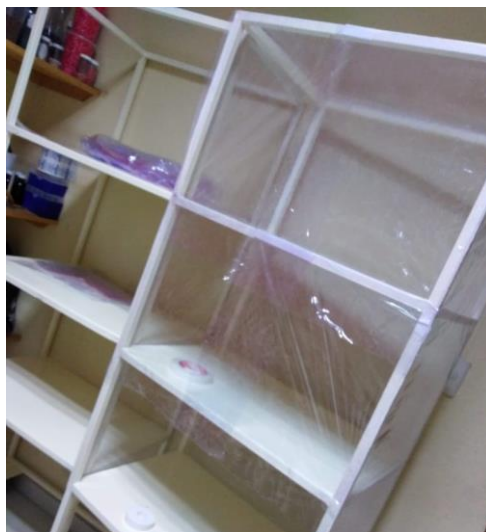
Figura 3. Jaula con hule de cristal, tipo cámara climática, para la cría de las poblaciones de S. frugiperda .
