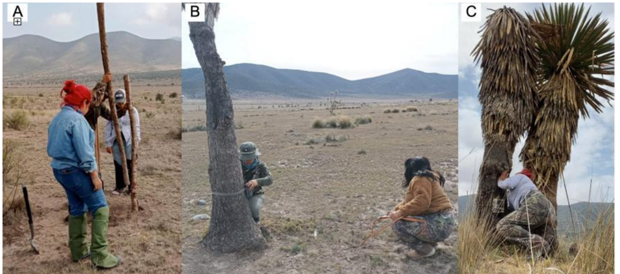
Figura 5 Instalación de estaciones de fototrampeo; A) colocación de postes para instalar cámaras; B) limpieza de campo de visión e instalación; C) activación de cámaras.
