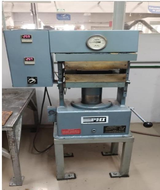
Figura 3 Termoconformadora
