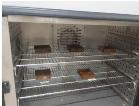
Figura 5 Envases en cámara climática
