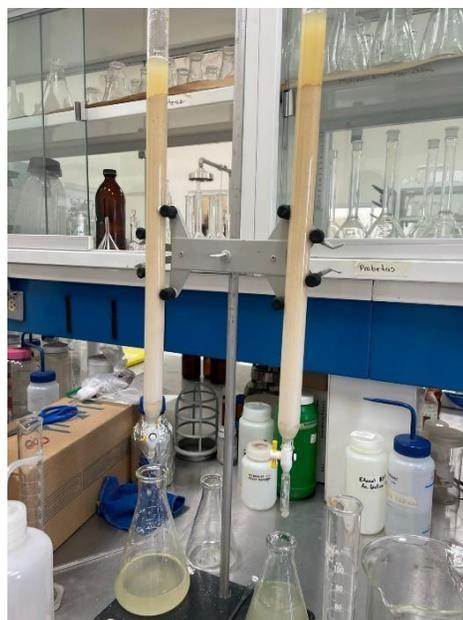
**Figura 5.** Separación y purificación de la fracción rica en compuestos fenólicos empleando Amberlita XAD-16.
