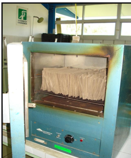
Figura 4.5. Introducción de las raíces y follaje a la estufa de secado durante 36 hrs a temperatura constante de 75 °C.
