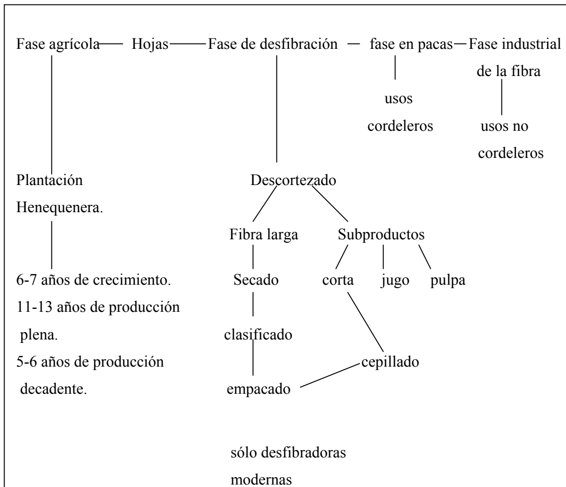
Figura 4. Proceso técnico de la producción e industrialización de henequén.
