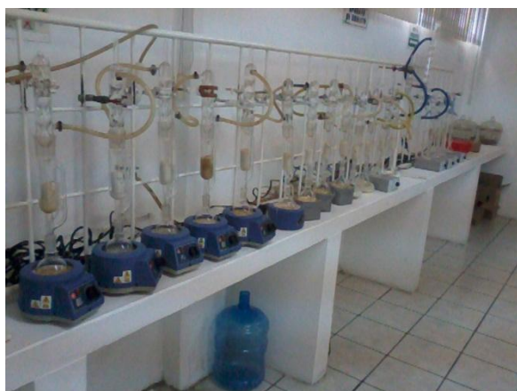
Figura 16. Sistema de extracción de los aceites de semilla de mezquite
