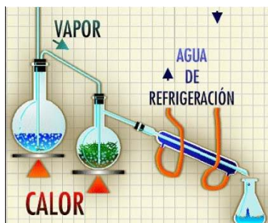
Figura 7. Esquema de extracción por arrastre de vapor
