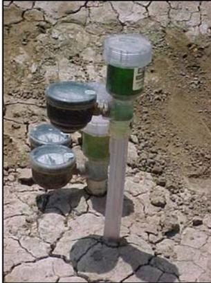
Figura 2.1. Tensiómetros.
