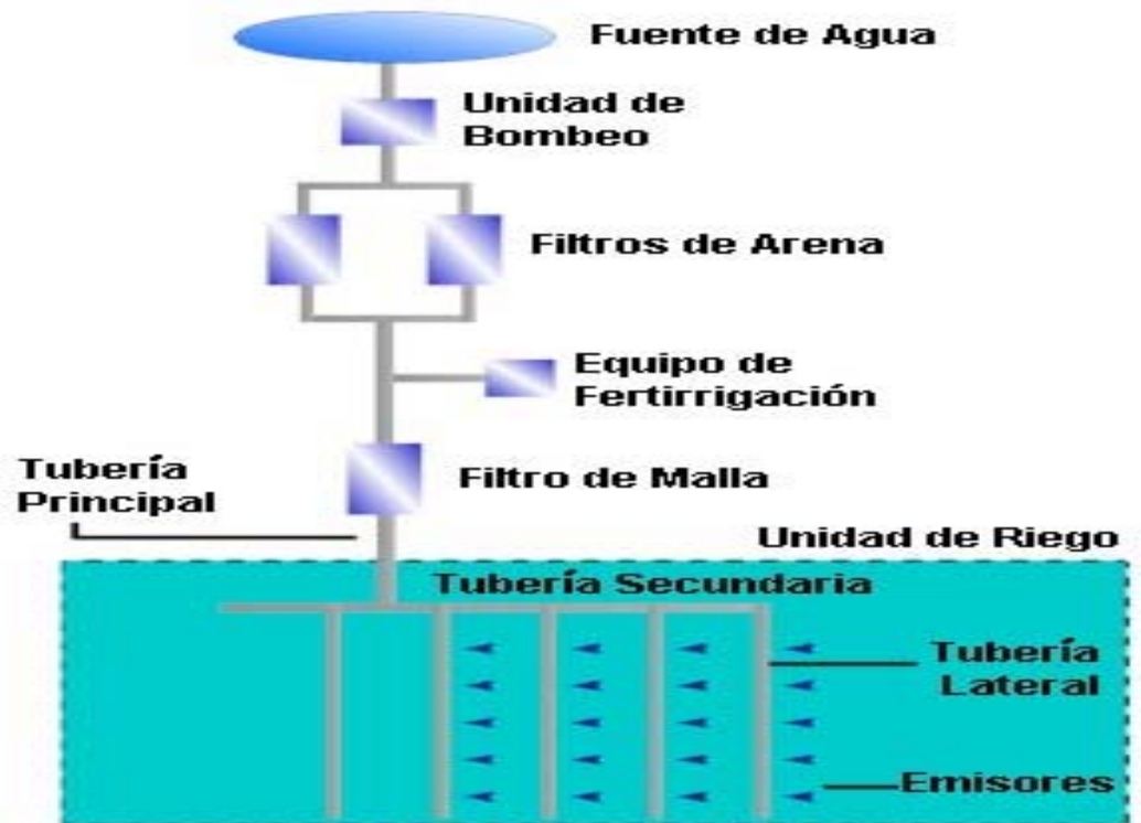
Figura No 2.6. Componentes del sistema de micro irrigación
